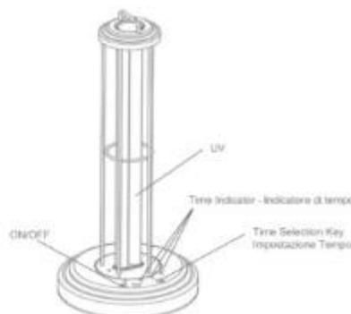
Лампа, излучающая ультрафиолетовый свет UVC. Бактерицидный эффект обусловлен разрушающим действием УФС-излучения на ДНК бактерий, вирусов, спор, грибов, плесени и клещей.
